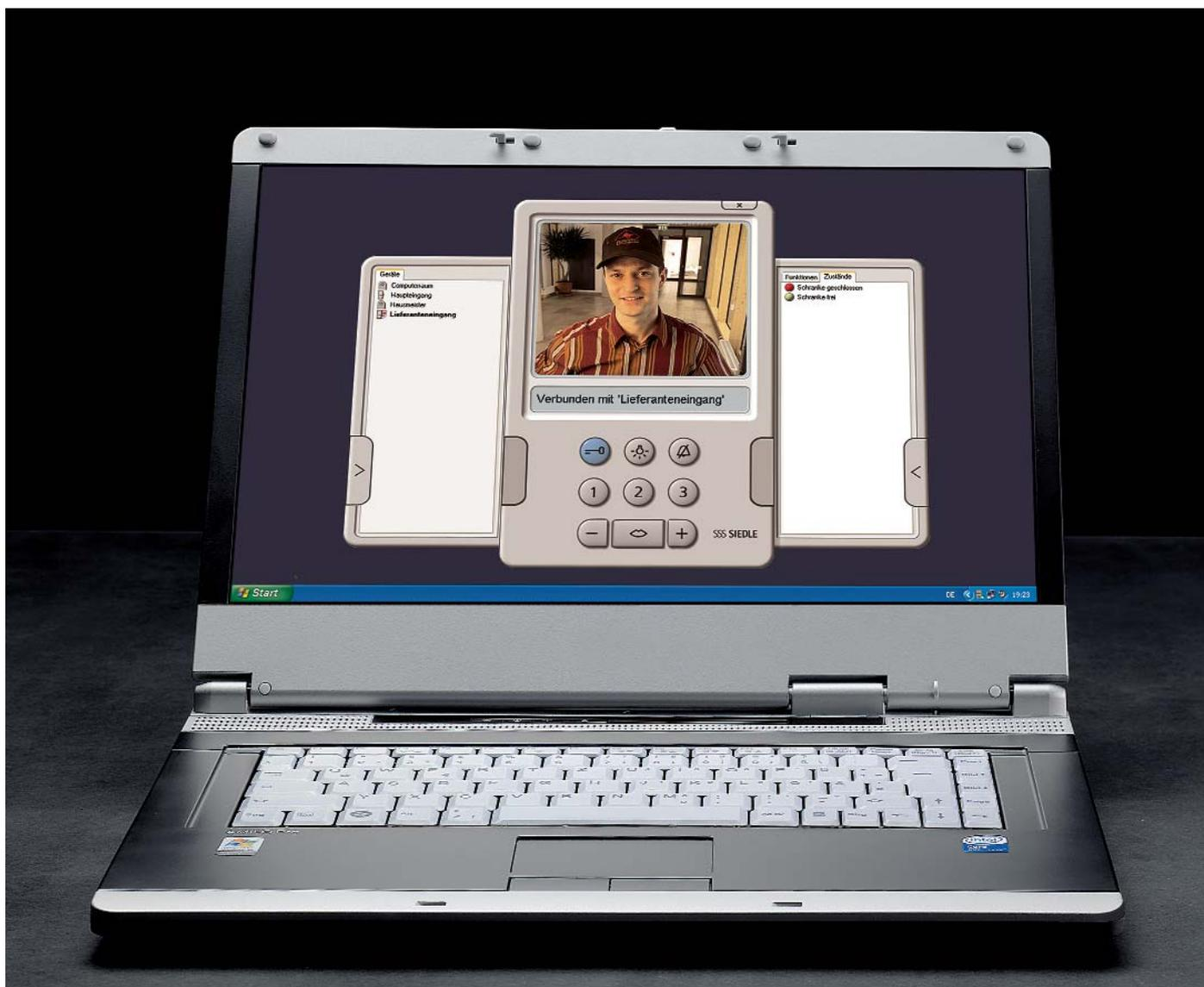
Stellen Sie sich vor: Die Türstation ist Teil Ihres IP-Netzwerks. Die Ruf-, Sprech- und Videosignale von der Tür werden im Netz übertragen und von einer Client-Software empfangen. Der PC übernimmt sämtliche Aufgaben einer Innensprechstelle, inklusive Videodarstellung, Türöffner, Schaltfunktionen und Statusmeldungen. Zusätzliche Haustelefone sind nicht mehr nötig – aber jederzeit möglich. Denn DoorCom-IP, die Schnittstelle zwischen Datennetz und Tür-
