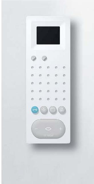
und Videotelefon gemein. Die vierte Taste des Videomodells schaltet die Türkamera manuell auf den Monitor; bei jedem Klingeln wird das Kamerabild automatisch angezeigt. Zwei Drehregler für Farbsättigung und Helligkeit regeln die Wiedergabe des 2,5-Zoll-Farbbildschirms.
